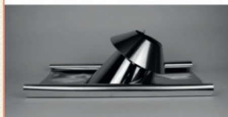
Dakdoorvoer (5-30 ° ) met aluminium/loodslab en stormkraag Ø130mm
